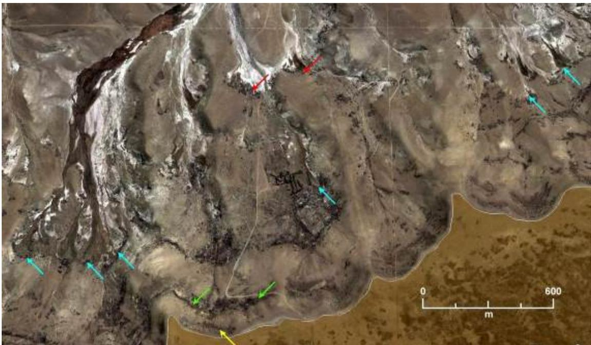
**Figura 137:** Afloramientos del Freático de Meseta situados a 10 km al sudoeste del eje de cierre proyectado. Se localizan a diferentes profundidades al interdigitarse banco impermeables dentro de la secuencia clástica terciaria. La pantalla parda claro corresponde a la Pampa Alta
