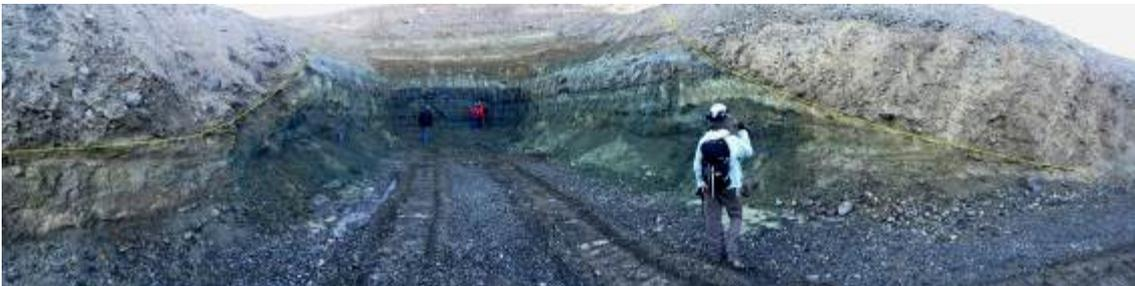
**Figura 116:** Superficie de falla cóncava de un deslizamiento rotacional. La traza amarilla señala el plano de falla.
