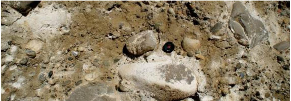
**Figura 72: Corte artificial del depósito correspondiente a las Morenas Cerro Fortaleza. El mismo se sitúa en la margen derecha del valle del río Santa Cruz, en el sitio del estribo de la presa proyectada.**
