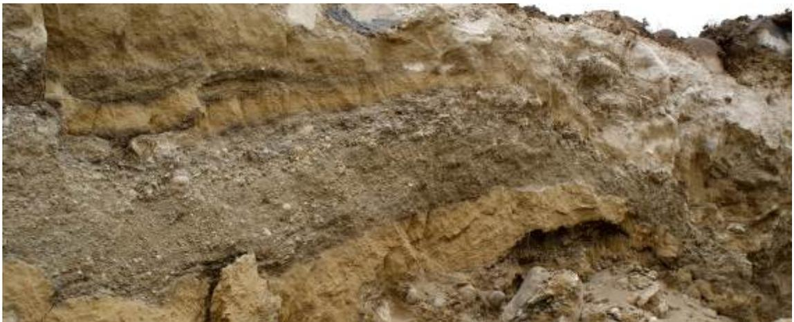
**Figura 73: Características estructurales y granulométricas internas del depósito correspondiente a las Morenas Cerro Fortaleza situadas en la margen izquierda del valle del río Santa Cruz, en el sitio de la presa proyectada.**
