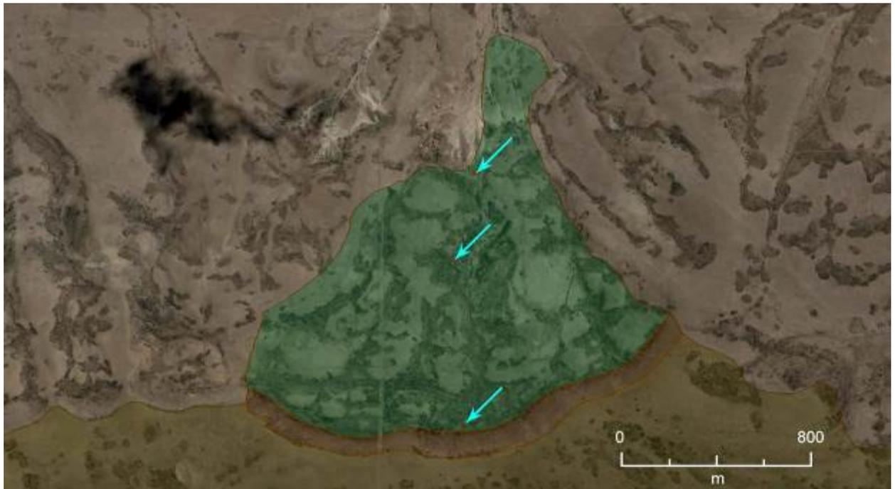
**Figura 35: Movimientos de remoción en masa (pantalla verde) en el cuerpo de las sedimentitas terciarias localizadas en la margen sur del valle del río Santa Cruz y su relación con afloramientos de acuíferos (flechas celestes). La pantalla amarilla corresponde a la planicie glacifluvial de la primera glaciación pedemontana y la pantalla marrón corresponde a la corona o cicatriz de los movimientos de masa ocurridos**
